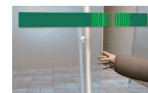
**Push&Go.** En complément du mode automatique, par simple poussée de la main dans le sens de l'ouverture, la porte s'ouvre puis se referme automatiquement, selon les paramètres enregistrés.
