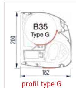
Différentes versions du B-35, du système ouvert (type A) au coffre entièrement fermé (type K). Le B-35 Prestige est uniquement disponible avec coffre fermé (type K) ou semi-fermé (type I). Le profil gouttière type G est disponible en option pour toutes les versions.
